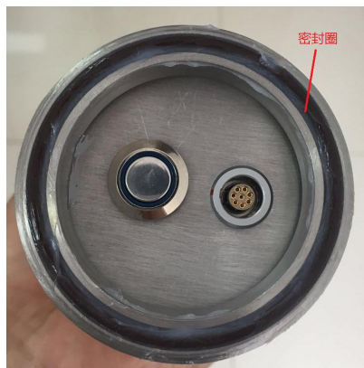
图 6.8 设备上端及硅橡胶圈（涂抹硅脂）
