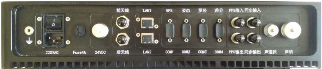
图 5.3 甲板单元后面板
