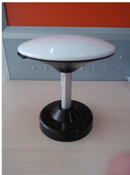
图 6.6 GPS 天线、磁吸盘和支撑杆
