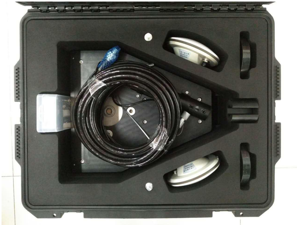
图 6.1 MS400 多波束系统水下探头装箱图
